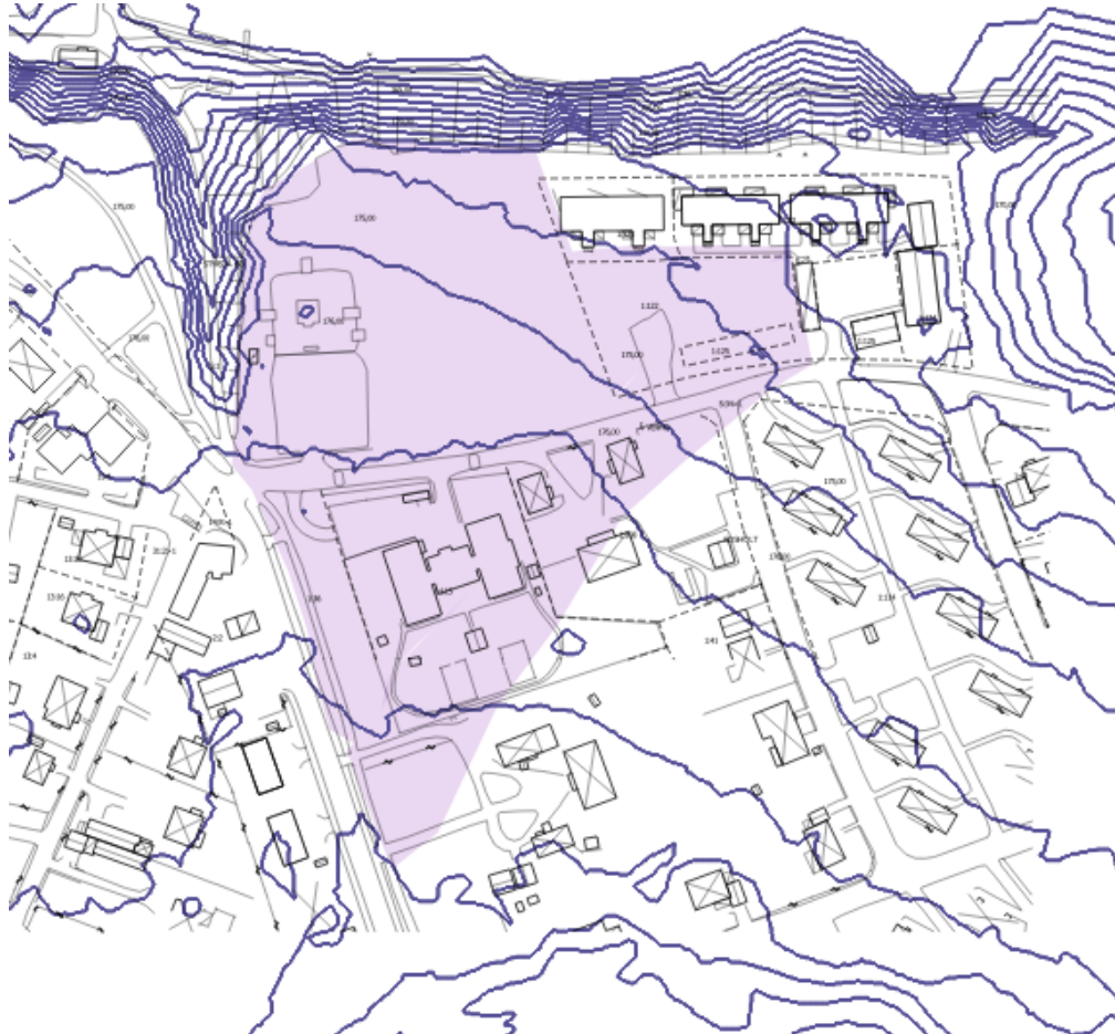
Figur 5. Ungefärligt område som avvattnas ned mot vägarna intill detaljplaneområdet. Avrinningsområdet och höjdkurvor är genererat i gis utifrån lasdata.
