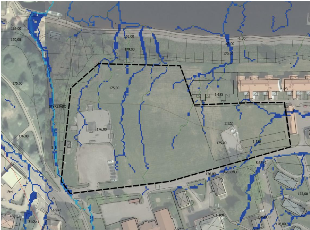
Figur 7. Genererade av flödesvägar i gis baserat på nationella höjddatabasen som 1 m grid. Den mer ljusblå-gula färgen väster om planområdet indikerar att fler celler avrinner mot detta stråk
